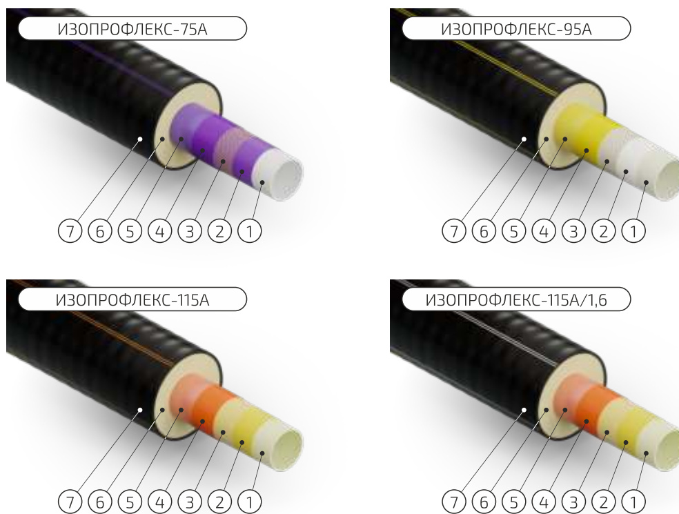
Рис. 11 Конструкция труб семейства ИЗОПРОФЛЕКС-А 1 - внутренний слой; 2 - адгезионный слой; 3 - армирующий слой; 4 - наружный слой; 5 - барьерный слой; 6 - теплоизоляционный слой; 7 - защитная оболочка
